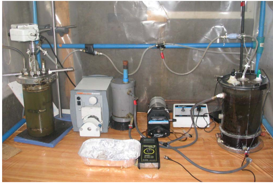
Figura 4. Montaje real del sistema de bioconversión anaerobia en dos etapas.
