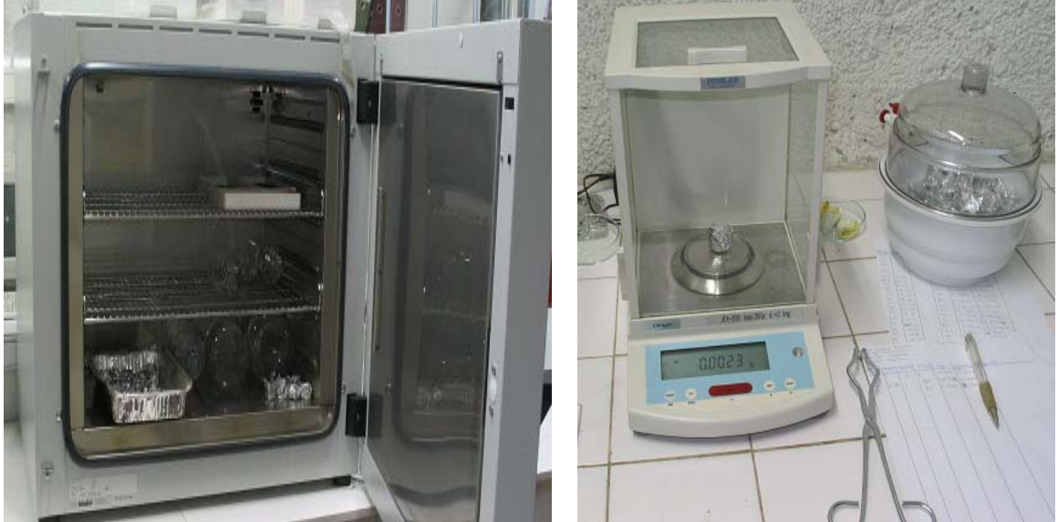
Figura 22. Procedimiento para la obtención de la masa de agua en la muestra de suelo.
