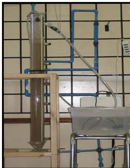
Figura 11. Montaje de la columna de infiltración en el laboratorio.
