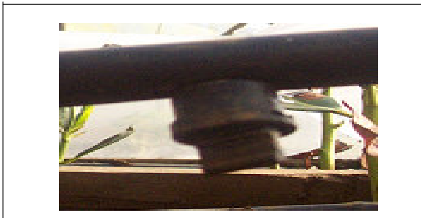
FIGURA 5 Vista del gotero de 4L/H conectado a la planza de ½ pulgada, utilizado en el ensayo
