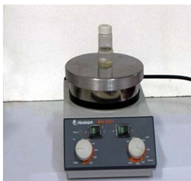
Fig. 2.5: Montaje experimental para el estudio de la acción de quitosano como adsorbente de proteínas
