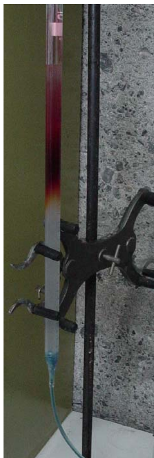
FIGURA 3. Columna de filtración molecular con gel Sephadex G - 50 y colorantes azul dextrano y rojo fenol.
