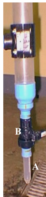
Figura 2. Detalle Columna de decantación. A: Tubo de centrifuga de 50 ml para colección de heces. B: llave de paso para extracción de tubo de centrifuga.
